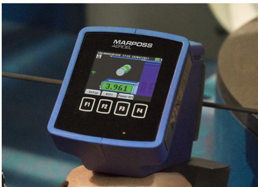
測徑儀可利用專屬設計的支撐架，以固定在機器上，此支撐架包含有一個辨識機器的標籤裝置，在量測的同時一併由儀器讀取。
